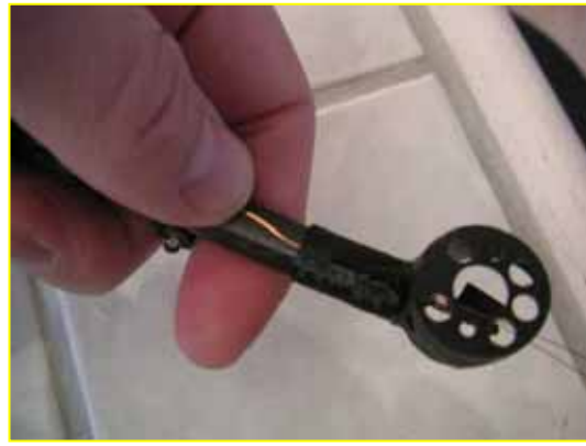
Maintenir le support de diodes, tendre les fils sans excès pendant que vous pousser le support moteur en place.
