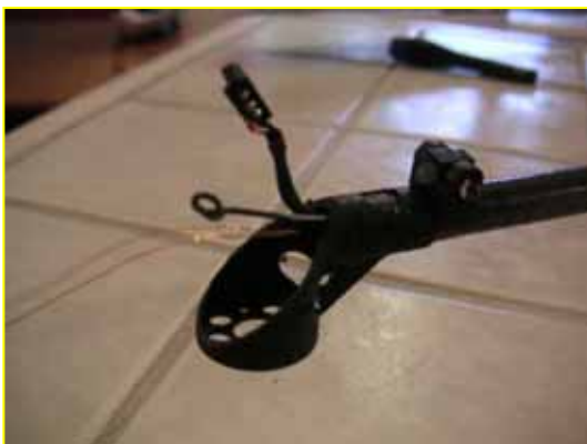
Le passe fils est sorti. Observer la boucle faite autour d'un tourne vis cruciforme.
