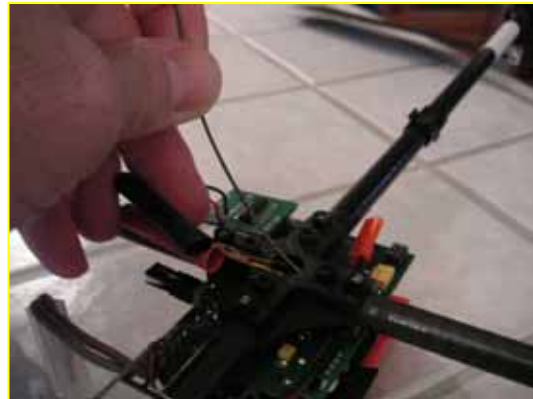
Tirer doucement les fils vers le centre En aidant l'entrée de ceux-ci à l'extrémité.
